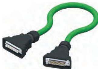
La connexion multipolaire est réalisée par un connecteur Sub-D 37 pôles et est en mesure de gérer au maximum 32 signaux électriques. Alternativement, il y a un connecteur Sub-D 25 pôles qui est en mesure de gérer au maximum 22 signaux électriques.
